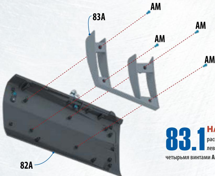
**83.1** **НАДЕНЬТЕ** КАРКАС 83А на штифты, расположенные на внутренней поверхности левой двери 82А. Зафиксируйте каркас четырьмя винтами АМ так, как показано на фотографии. ◀
